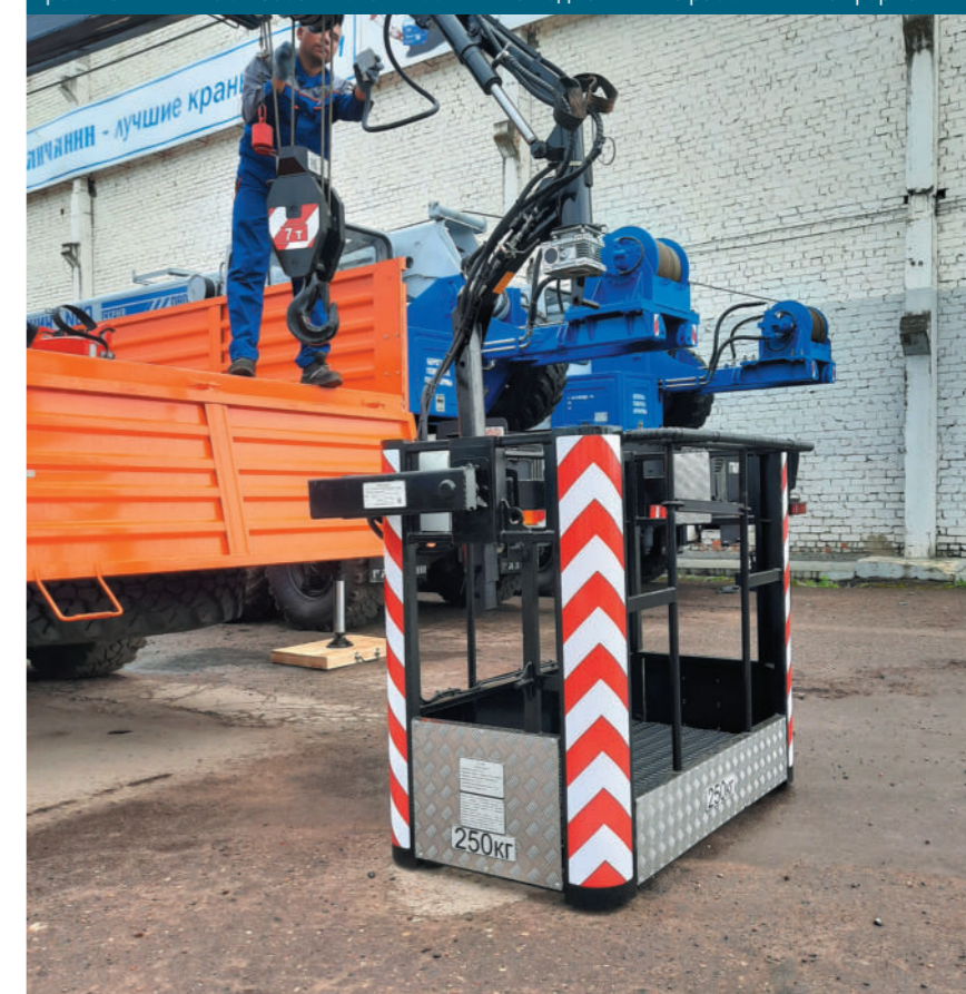
Краноманипуляторная установка КМУ-150 «Галичанин» изготовлена в соответствии с требованиями ГОСТ 53037-2013 «Мобильные подъёмники с рабочими платформами»
